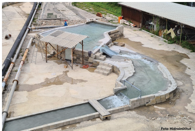
Slika 4. Fizični hidravlični model pregrade Pod Sušo v merilu 1:25, izdelan na zunanji laboratorijski ploščadi Inštituta za hidravlične raziskave (Foto: Jurij Mlačnik).
